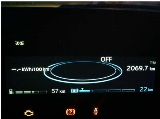
En este viaje quiero poner a prueba las posibilidades del extensor de autonomía, el generador con el motor bicilíndrico de 650 cc -que también monta la maxiscooter de BMW- que irá generando energía eléctrica bajo demanda cuando agote el remanente de las baterías de 22kw.
